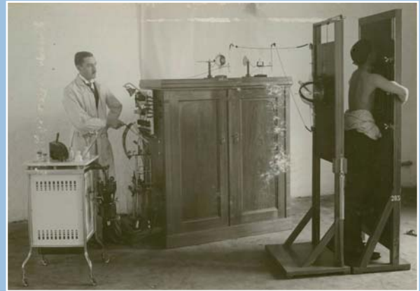
Universal-Induktor-Röntgenapparat (für therapeutische Bestrahlungen, Durchleuchtungen, Zeit- und Schnellaufnahmen) der Firma Reiniger, Gebbert & Schall (RGS) aus dem Jahr 1912, mit Untersuchungsapparat/Stützwand. SRE MED Archiv Erlangen
